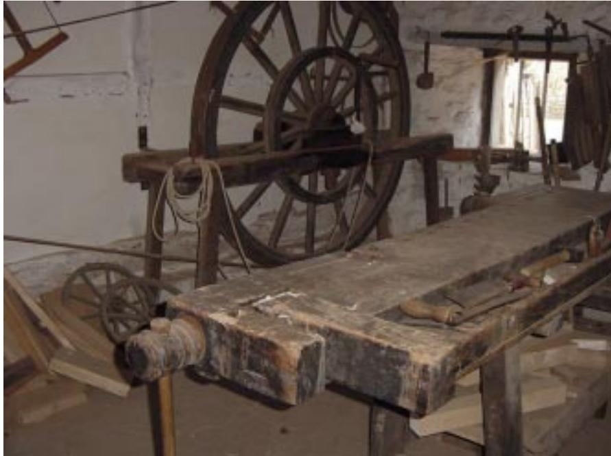
(Abb. : Schwungradkonstruktion und Drehbank in ELSIG )
